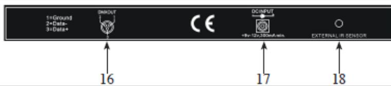
16. DMX OUT - Utilizzata per inviare segnali DMX alle apparecchiature a LED compatibili.
